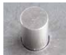
Foro da 25 mm con l'uso della tecnologia True Hole con plasma HPRXD
