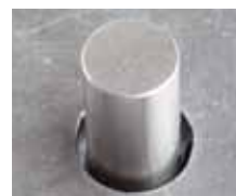
Foro da 25 mm senza l'uso della tecnologia True Hole con plasma HPRXD
